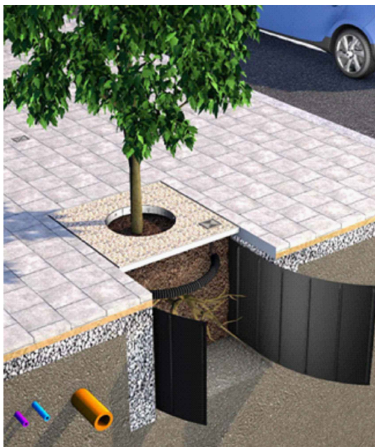
Skica sustava za upravljanje rasta korijena uličnih stabala
